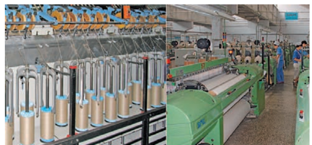
Verspinnen des Faserbandes und anschliessendes verweben des fertigen Garnes.
